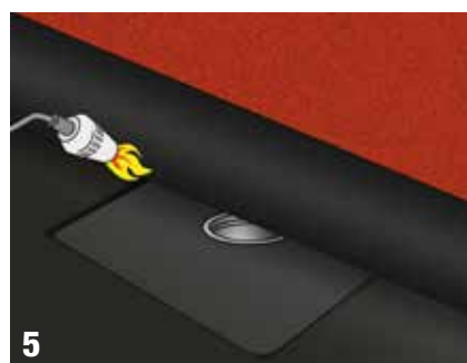
5 Mettre en œuvre la deuxième couche d'étanchéité par thermo-soudure en recouvrant totalement la naissance EEP MOPLAS.
