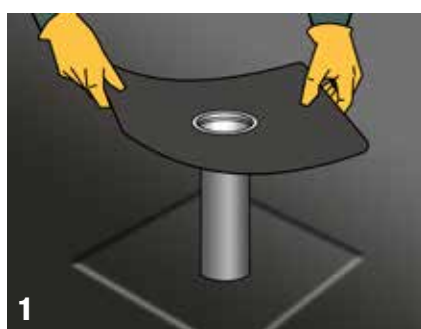
1 Insérer l'EEP MOPLAS dans la réservation après avoir posé la 1ère couche d'étanchéité.
