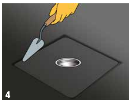
4 Conforter à la langue de chat les soudures de la platine avec la 1ère couche d'étanchéité.
